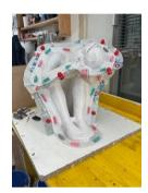
La première étape consiste à exécuter un moule en silicone en contact avec la pièce ensuite recouvert d'une coque en plâtre.
