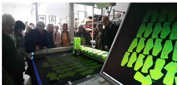
La découpe de toutes les pièces d'une même chaussure est totalement automatisée et gérée par ordinateur car les formes sont nombreuses. Elle se fait par lame (comme un scalpel) et non au laser qui abimerait le cuir.
